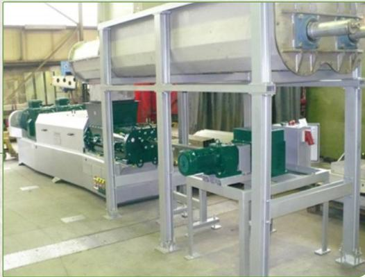
Neuartige Substrate für Ihre Biogasanlage durch Extrusion
